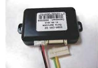
4) При правильной последовательности действий модуль SOBR-CAN 02 будет обнаружен программой автоматически. Если этого не произошло, выполните действия согласно инструкции на устройство SOBR-CAN Config.
