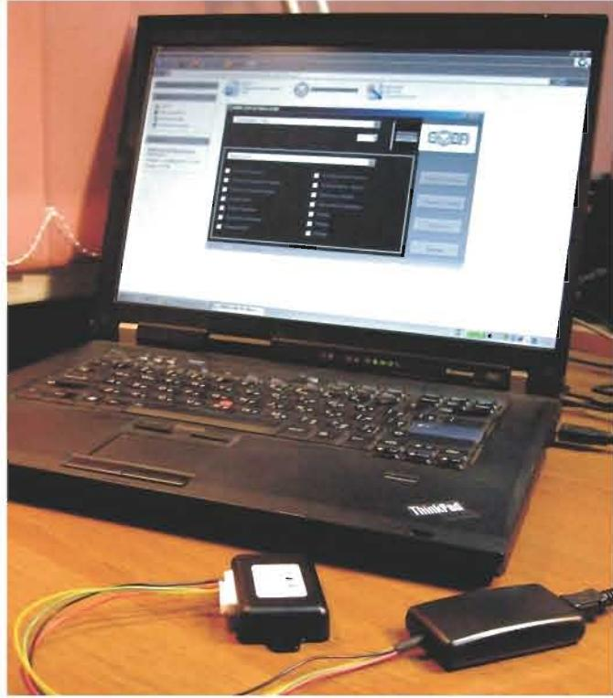
Перед установкой на автомобиль необходимо проверить наличие обновлений ПО и запрограммировать модуль. Для этого требуется компьютер, устройство «SOBR-CAN Config», программное обеспечение «SOBR-CAN» (поставляется с SOBR-CAN Config).
