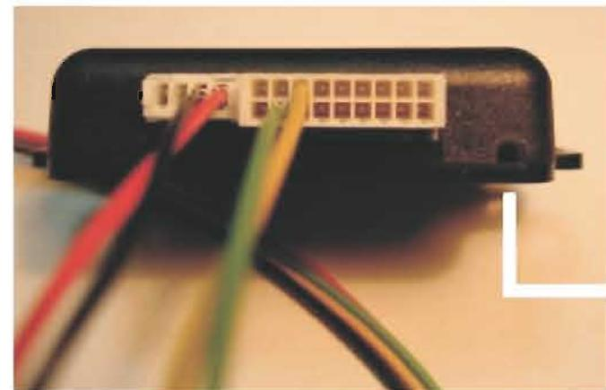
10) Отключите 18-тиконтактный и 4-хконтактный разъёмы.
