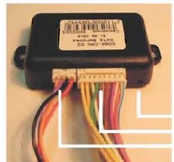
Расположение разъёмов и индикатора на корпусе устройства.
